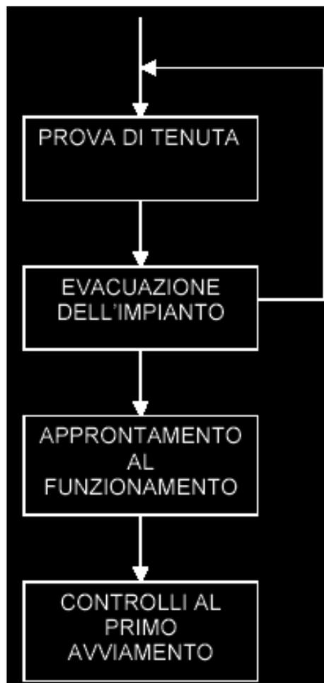
Fig. 3-1 Prova di messa in servizio dell'impianto
