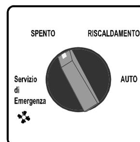
Fig. C.3: Selettore della modalità di funzionamento
