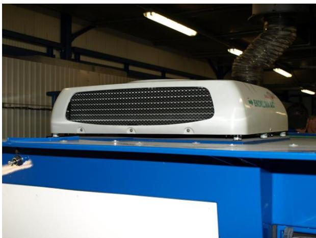
Ispezionare visivamente le lamelle del condensatore situato nella testata del contenitore presente sul tetto: è possibile che queste lamelle siano sporche di insetti, peluria, foglie, polvere e altre impurità che riducono l'efficienza termica dello scambiatore. Per pulire lamelle eliminare le impurità aspirando o soffiando l'aria nel senso contrario a quello del tiraggio del ventilatore.
