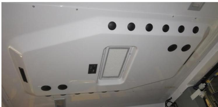
Il pannello nel controsoffitto fissato al soffitto della cabina serve per distribuire l'aria all'interno della cabina per mezzo di ugelli ad aria; il pannello supporta inoltre il pannello di comando e il filtro d'aspirazione.
