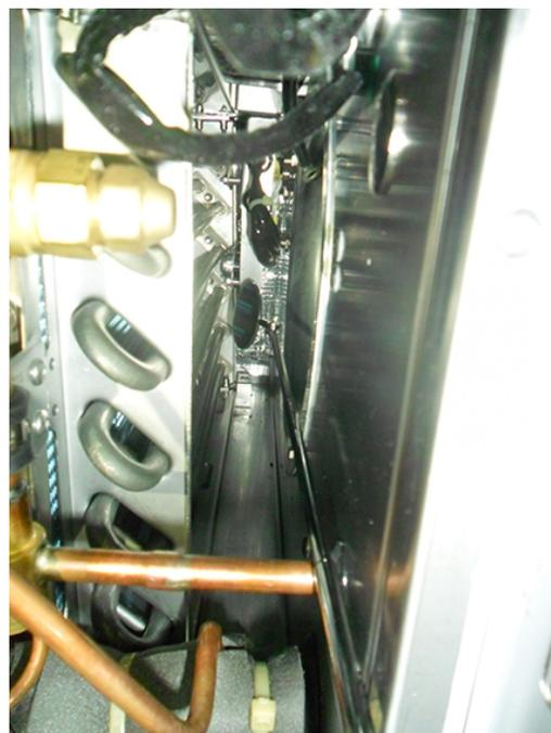
Fig. 3 Dettaglio della batteria evaporante del modulo HVAC di cabina
