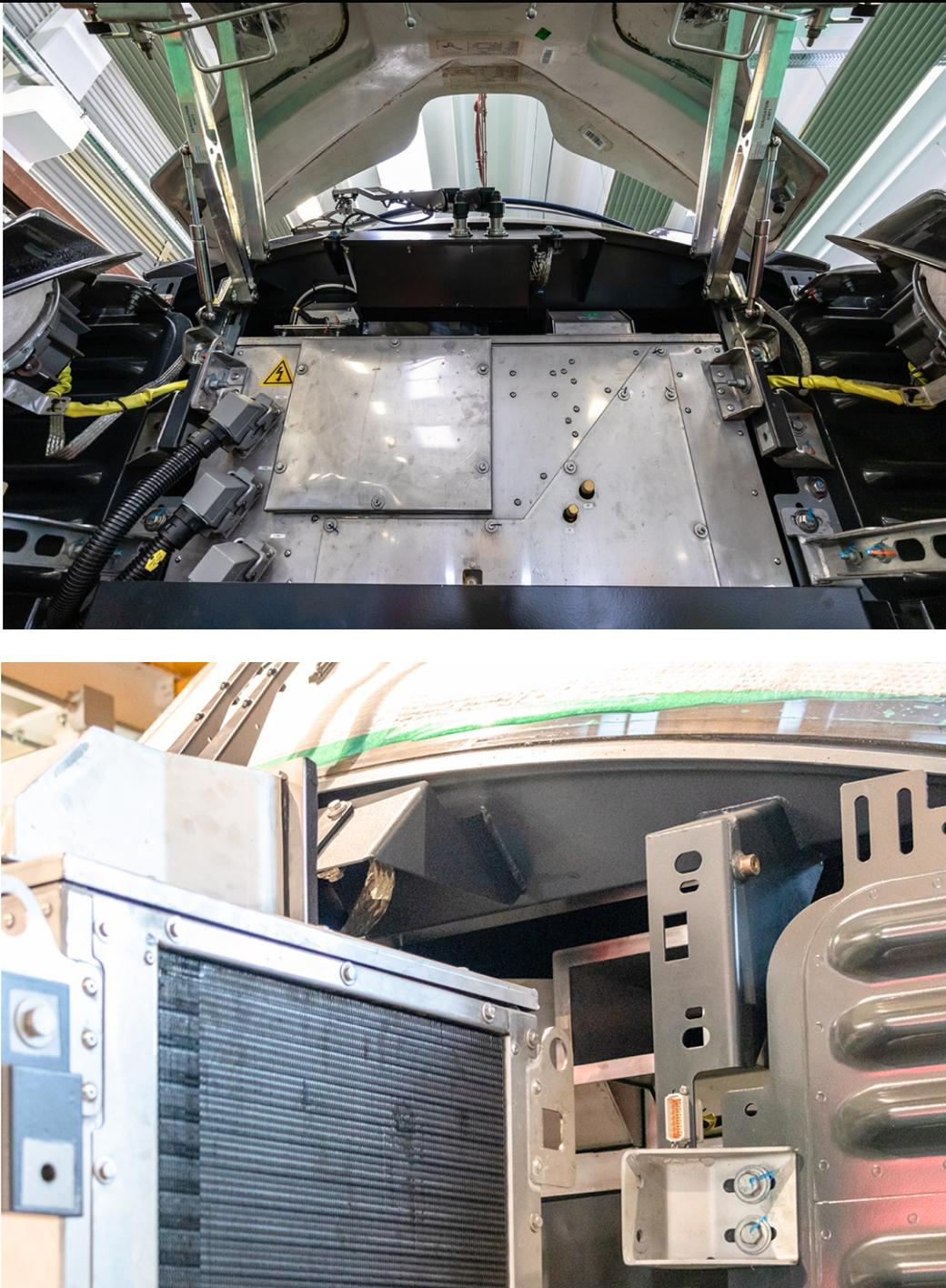
Fig. 1 Vista del modulo HVAC di cabina con dettaglio estrazione
