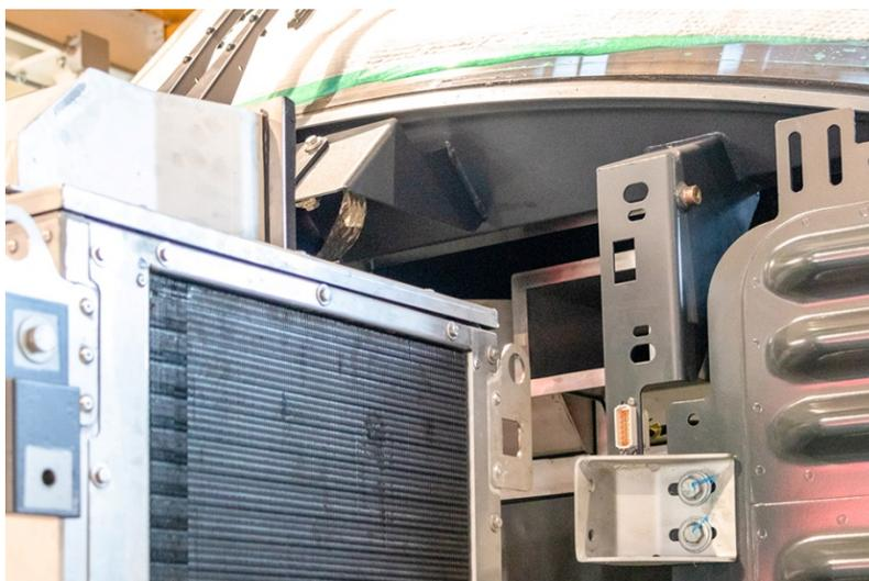
Fig. 1 Vista del modulo HVAC di cabina con dettaglio estrazione
