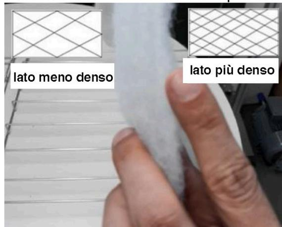
10. Posizionare il feltro filtrante sopra la parte di telaio #1 con l'accortezza che il lato più denso sia rivolta verso l'alto.
