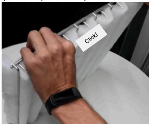
16. Controllare che i lati più denso e meno denso del feltro siano posizionati correttamente; il tempo necessario per installare il feltro all'interno del telaio è di circa 1 minuto per ciascun filtro.
