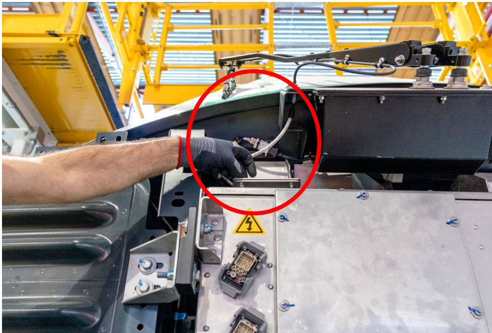
Fig. 2 Scollegamento/collegamento tubazione tergicristallo
